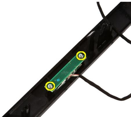
17. Retire a placa de Bluetooth com o respectivo cabo.
