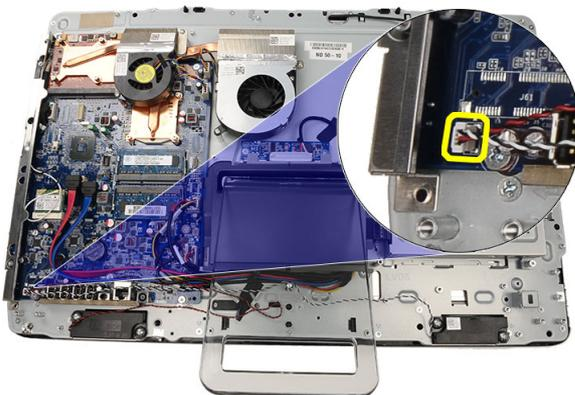
6. Retire os parafusos que fixam os altifalantes à placa de sistema.
