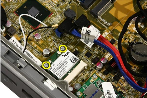
7. Puxe a placa WLAN para fora e retire-a do computador.
