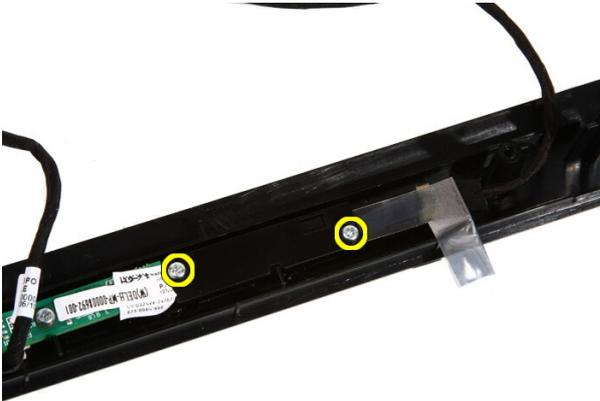
16. Retire a placa da câmara juntamente com o cabo.
