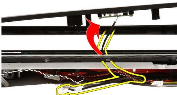
25. Com cuidado, encaminhe o cabo de IR e o cabo da câmara para fora ao longo da ranhura de encaminhamento.
