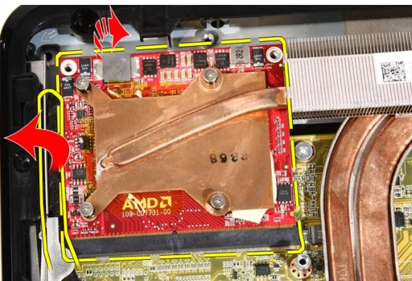
8. Retire os parafusos que fixam o dissipador de calor à placa de vídeo MXM.
