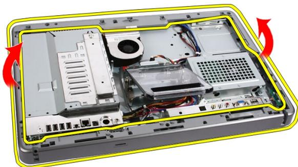
7. Se for necessário, levante ligeiramente a moldura central, junto às portas no lado direito do computador. As patilhas na parte inferior da moldura central engatam no chassi aqui.
