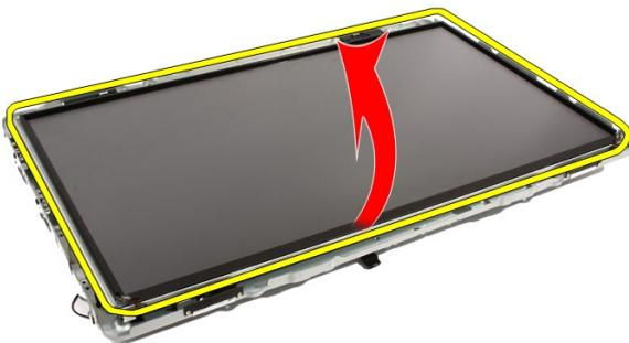
16. À medida que levanta o painel, assegure-se que os quatro cabos se soltam dos orifícios de encaminhamento.
