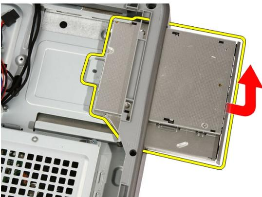
6. Retire a moldura da unidade óptica, para utilizar com a unidade óptica de substituição.
