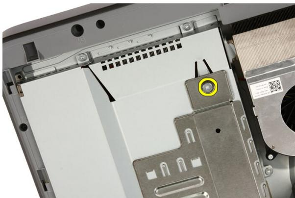
4. Faça deslizar a tampa da memória em direcção à parte superior do computador.
