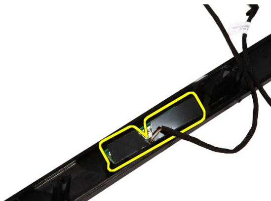
16. Retire os parafusos que fixam a placa de Bluetooth à moldura frontal.
