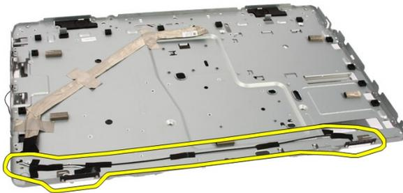
18. Retire os parafusos que fixam a antena ao chassis.
