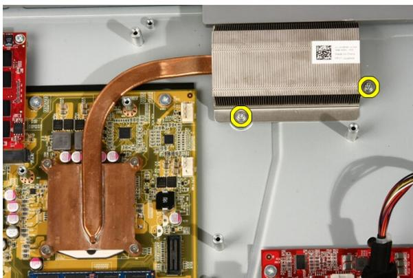
9. Retire os parafusos que fixam o dissipador de calor à placa de sistema.
